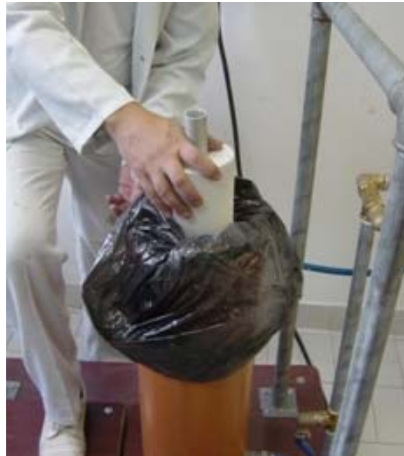
Simulation des Eintauchens in den Sand
